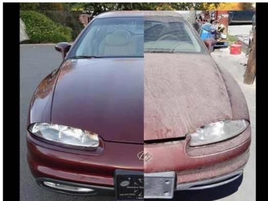
*Figura 1. Detallado exterior de vehículo con daños en la carrocería por contaminación ambiental*
