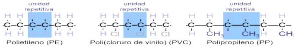
Figura 1. Ejemplo representativo de tres polímeros diferentes en donde se aprecia la unidad repetitiva correspondiente y el grupo funcional representativo para el polietileno (átomo de H), el poli(cloruro de vinilo) (átomo de cloro) y el polipropileno (grupo metilo,  $CH_3$ ), respectivamente.
